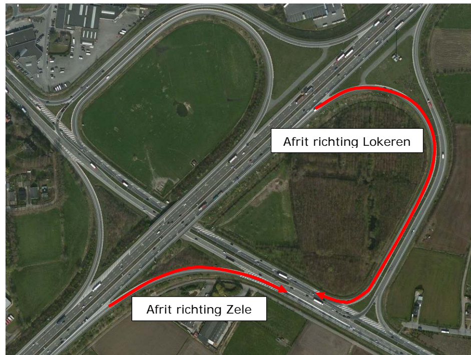
Op- en afrittencomplex Lokeren (E17): ontdubbelde afrit richting Antwerpen
